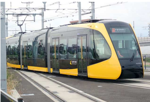
写真4 全車両低床構造
